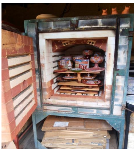
Figura 4. Forno 02 carregado com peças de cerâmica esmaltada já queimadas, esperando descarregamento
