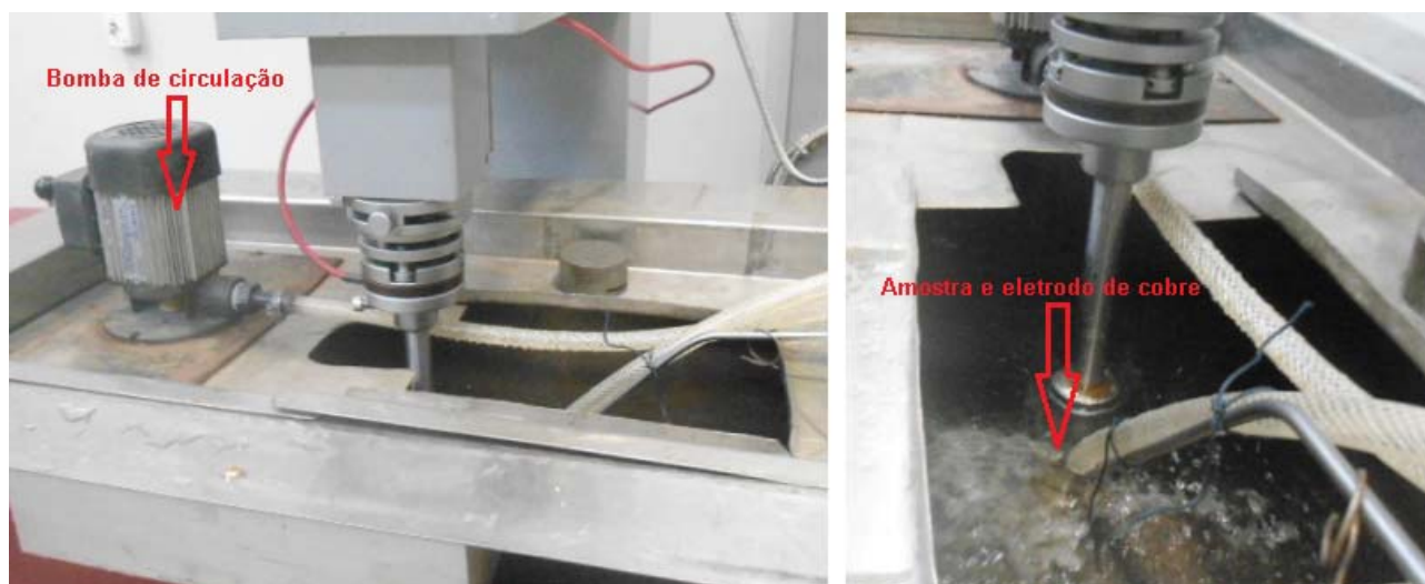
Figura 1: Máquina de EDM acoplada ao sistema de NDE.
