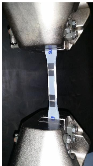
Figura 5. Corpo de prova preparado na máquina para ensaio mecânico de tração.
