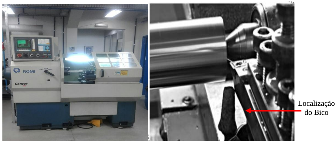
Figura 1. Montagem do Experimento: (a) Torno CNC ROMI, (b) Detalhe da Localização do Bico
