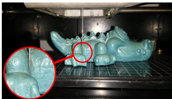
Figura 2. Processo de digitalização Roland Modela MDX-20
