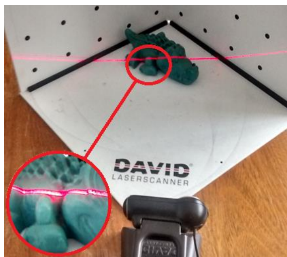
Figura 4. Processo de digitalização David Scan Starter Kit
