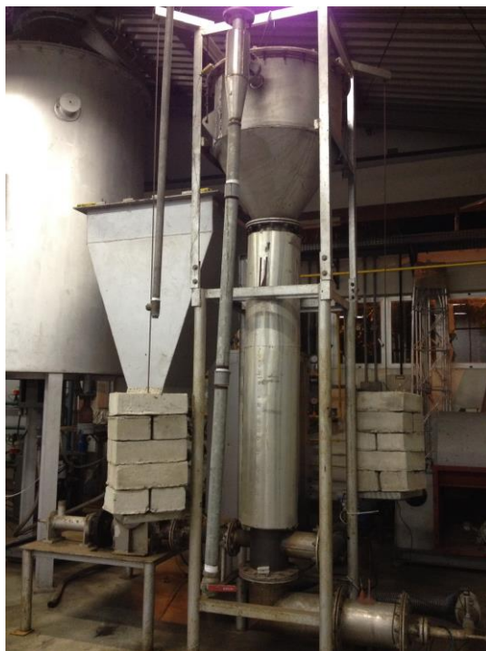
Figura 1. Gaseificador de leito fluidizado do laboratório. Fonte: Autor (2016).
