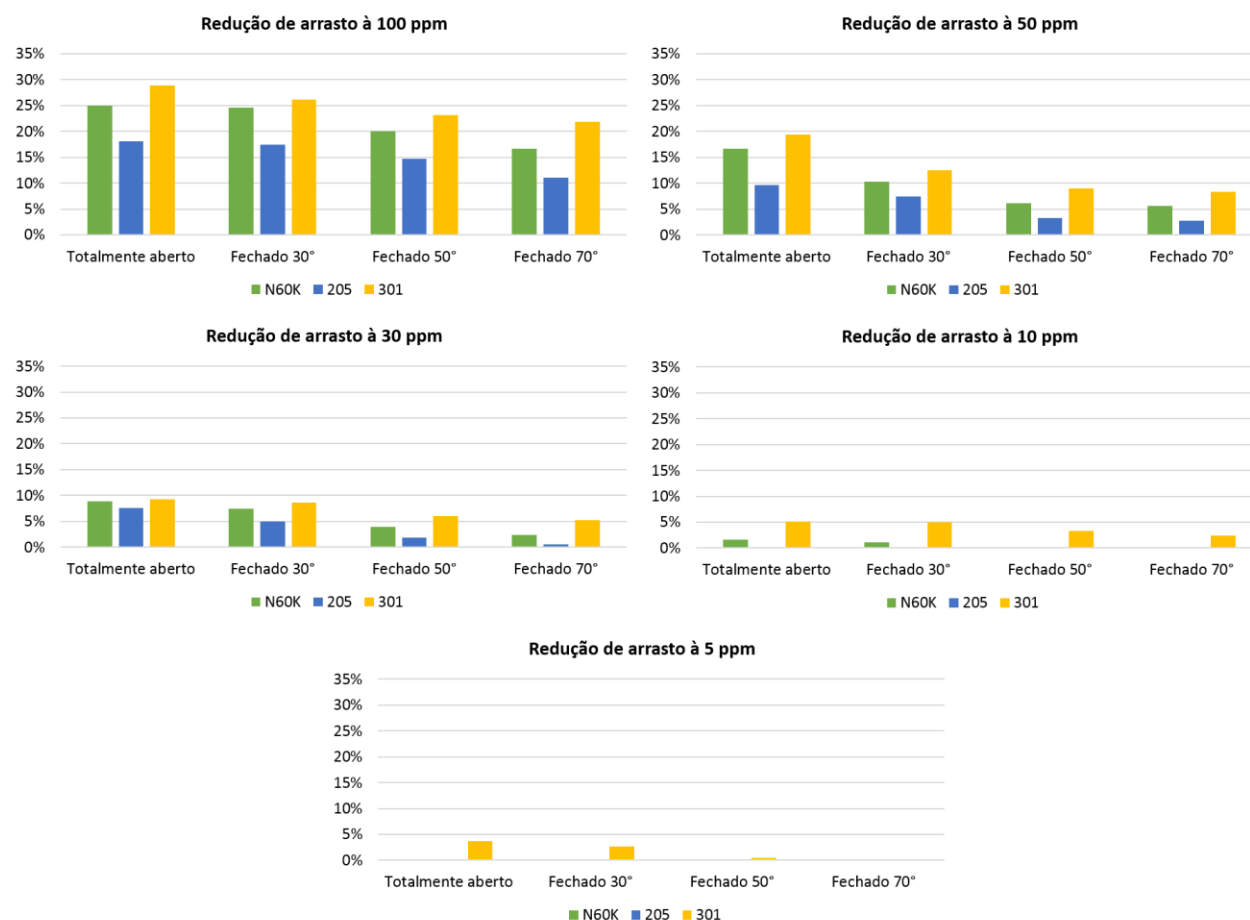
Figura 6. Redução de arrasto versus as posições da válvula para as concentrações poliméricas (Autoria Própria).
