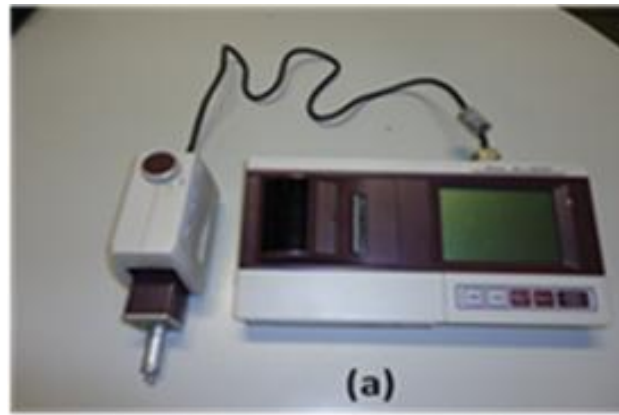
Figura 3.5. Rugosímetro surftest SJ-400 Mitutoyo.
