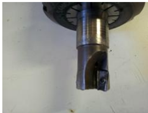
Figura 3.4. Fresa modelo R390-020A20-11L.
