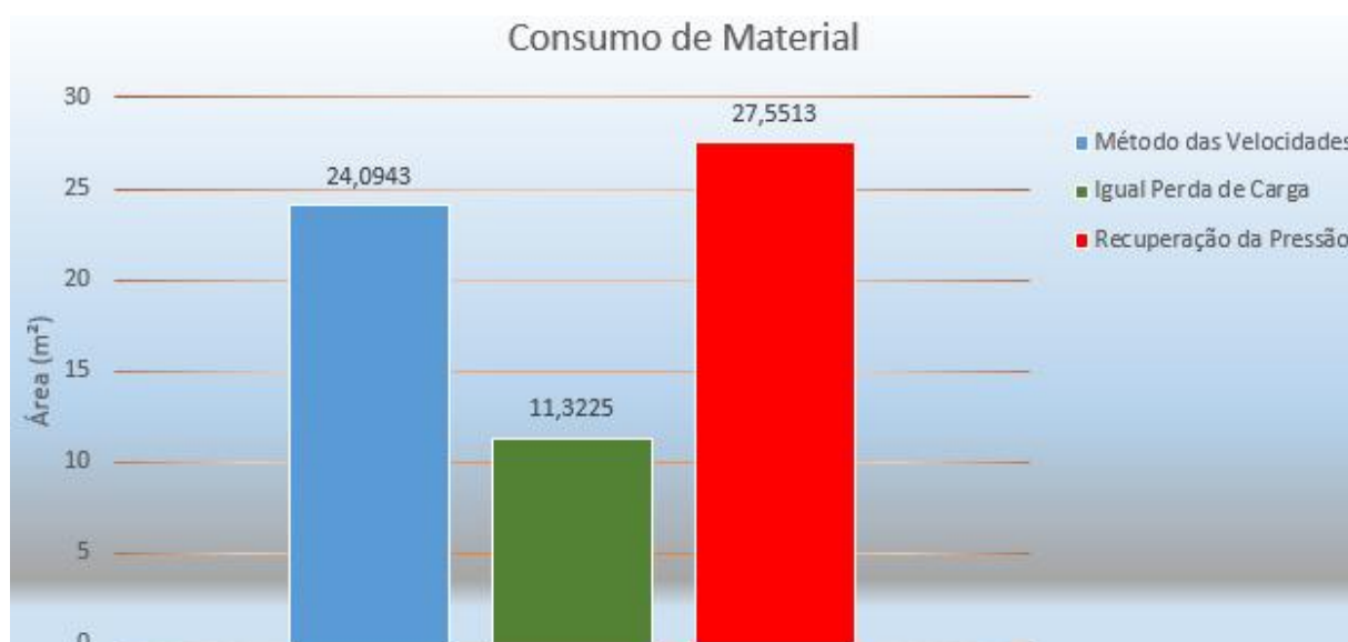
Figura 7. Comparação do consumo de material dos diferentes métodos de dimensionamento.
