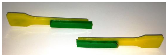
Figura 6. Corpos de prova rompidos durante o ensaio de tração
