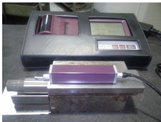
Figura 1. Rugosímetro e dispositivos para medição dos parâmetros avaliados.
