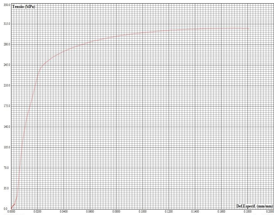
Figura 4: Curva de tensão – deformação do corpo de prova 2. Fonte: Autor
