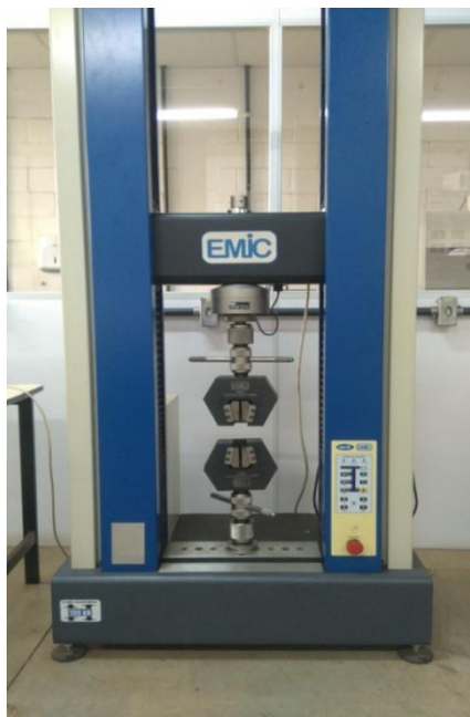
Figura 1: Equipamento utilizado no ensaio de tração dos corpos de prova de aço. Fonte: Autor
