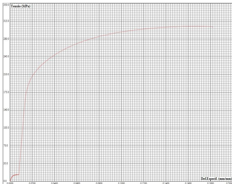
Figura 3: Curva de tensão – deformação do corpo de prova 1. Fonte: Autor
