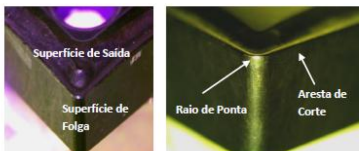
Figura 5. Imagem da pastilha utilizada no ensaio de usinagem para amostra A5-b-30. Microscopia Óptica, aumento de 15X.
