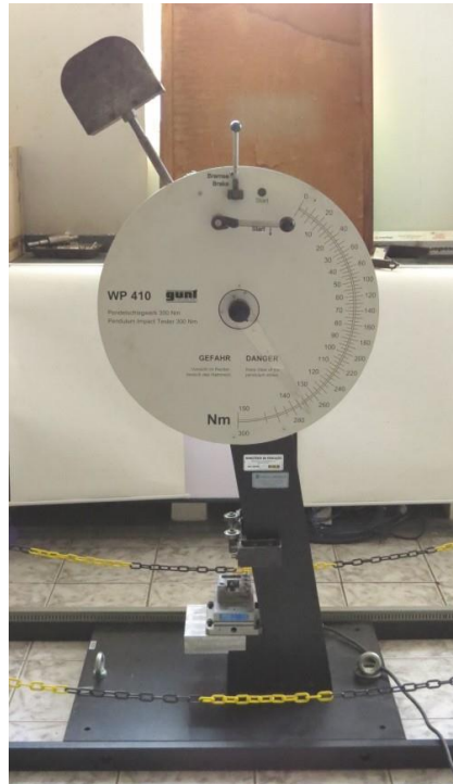
Figura 4. Equipamento adaptado para ensaios de esclerometria pendular.
