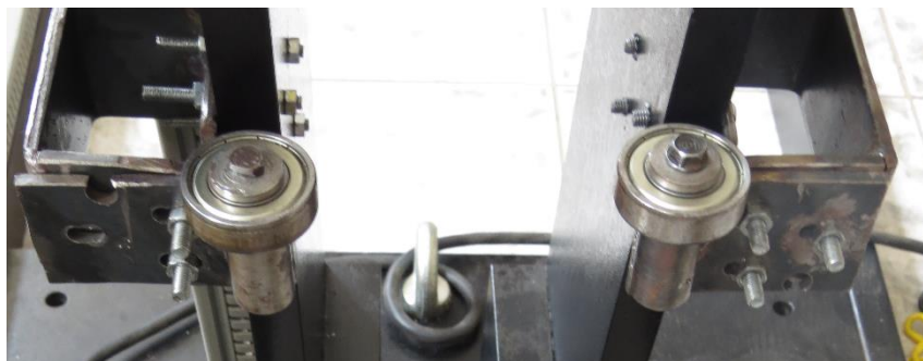
Figura 2. Mancais de rolamentos adaptados para controle da trajetória.
