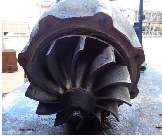
Figura 4. Foto do novo rotor em ASTM A890 Gr. 5A das bombas de circulação da coluna de Quench
