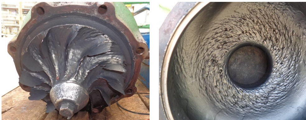
Figura 3. Fotos do rotor e voluta originais em DIN 1.4317 das bombas de circulação da coluna de Quench
