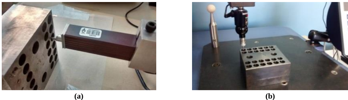
Figura 7. Verificação da qualidade dos furos: (a) medição de rugosidade com rugosímetro portátil SJ-201P; (b) medição dos desvios de circularidade com MMC Mitutoyo QM-Measure 353
