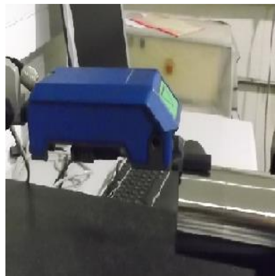
Figura 3 (b) Rugosímetro utilizado nas medições
