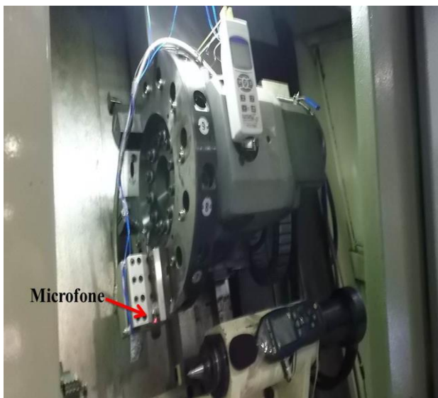
Figura 3 (a) Posição do microfone na máquina
