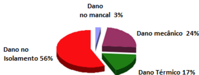
Figura 1. Danos em hidrogeradores (Bruetsch et al. 2008).
