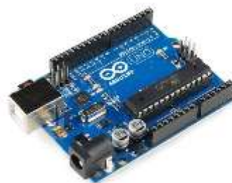
Figura 14. Placa Arduino R3 utilizada para realizar sequências específicas de movimentos com os atuadores.
