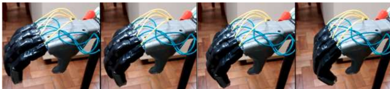
Figura 19. Raio de curvatura reduzindo ao modo que se aumenta a diferença de tensões nos atuadores superiores e inferiores.
