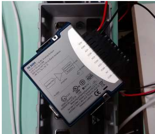
Figura 12. Módulo de controle analógico NI9263 da National Instruments.
