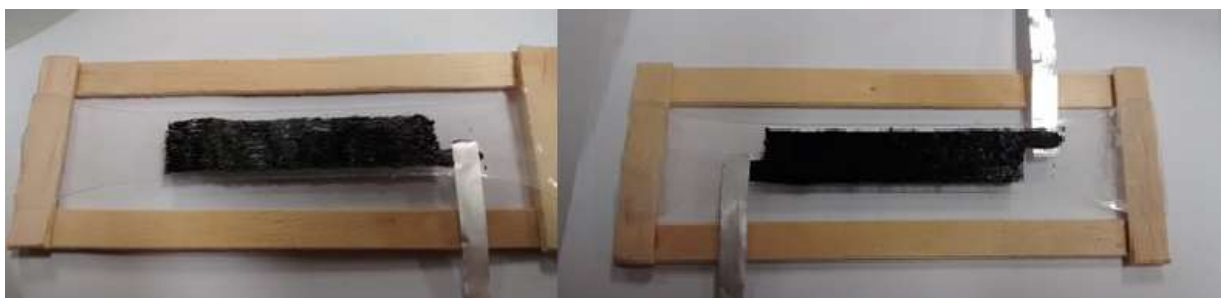
Figura 10. As primeiras duas camadas do polímero pintadas com graxa grafite servindo como o eletrodo flexível.
