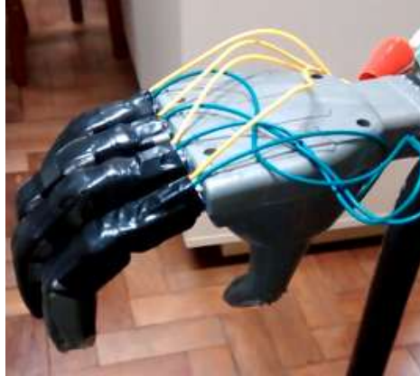
Figura 11. Mão com os atuadores instalados e fios conectados.
