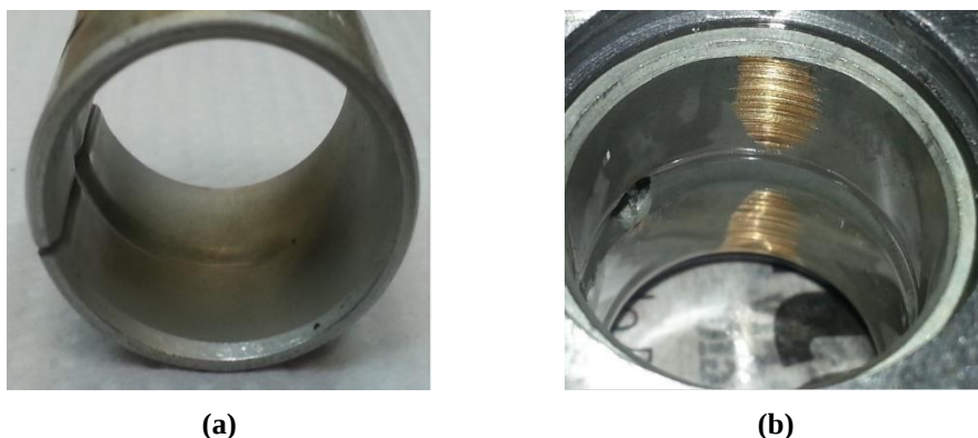
Figura 11: Aspecto visual do mancal antes (a) e depois (b) dos ensaios.
