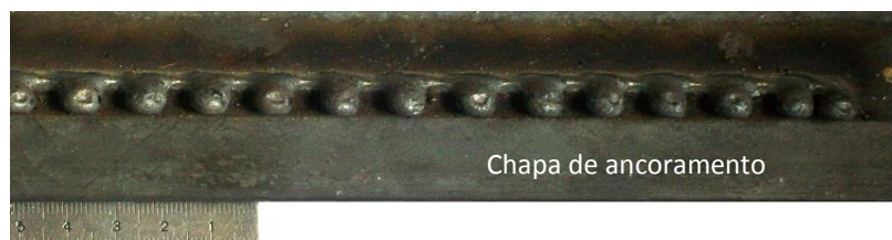
Figura 4: Ensaio P13 soldagem MIG/MAG arame frio com uso de chapa de ancoramento
