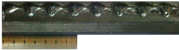
Figura 2: Teste P1 com a formação de humping durante a soldagem
