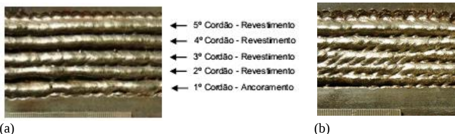
Figura 5: Cordão de solda MIG/MAG convencional: (a) distância entre passes de 5 mm (ensaio P14); (b) distância entre passes de 3 mm (ensaio P16)
