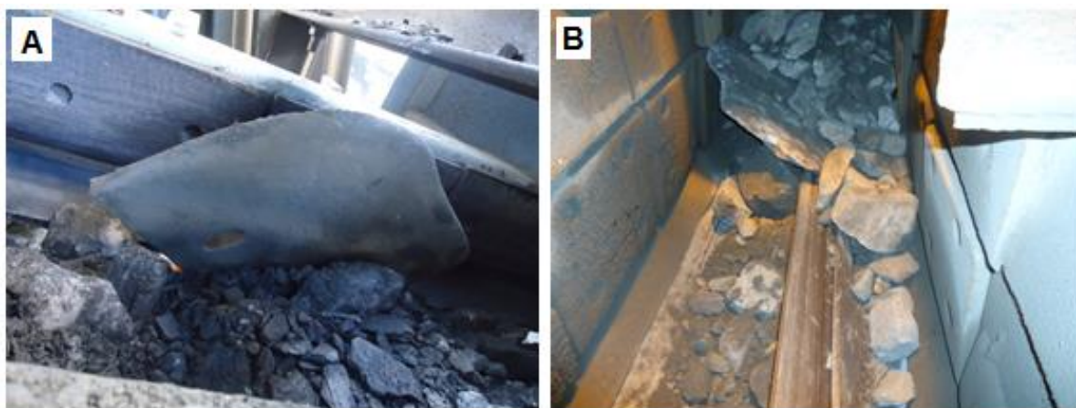
Figura 4. Rasgo de correia por material metálico (A) e por lamela do minério (B). Acervo técnico da unidade de britagem analisada (2015).
