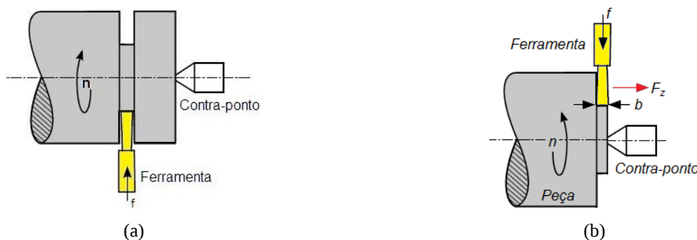
Figura 1: Torneamento radial com ferramenta de sangrar: (a) corte de canal; (b) faceamento.
