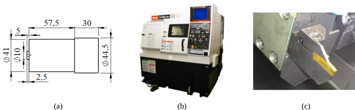
Figura 3: (a) Esquema representativo de um corpo de prova após uma etapa de faceamento (dimensões em mm); (b) Torno CNC Mazak QTN 100-II; (c) Ferramenta de corte utilizada nos experimentos.
