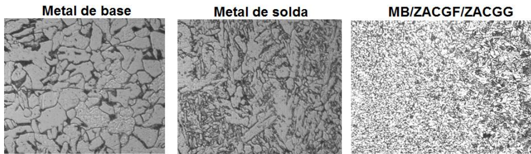
Figura 15. Exemplos de micrografias de solda realizada pelo GMAW STT.
