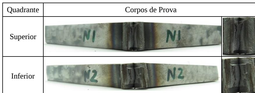
Figura 13. Detalhe da área de ruptura do corpo de prova quadrante superior(N1) e inferior (N2) após ensaio de Nick-Break (teste 17).
