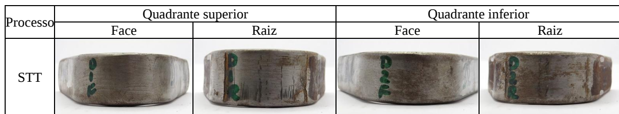
Figura 9. Corpos de prova após ensaios de dobramento, com indicações de trincamento.
