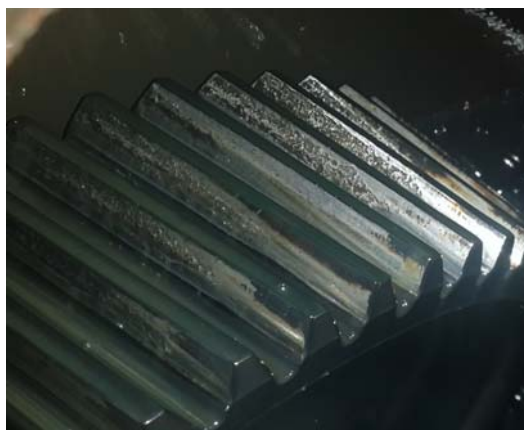
Figura 3. Lascamento da superfície dos dentes de uma engrenagem causado por fadiga de contato
