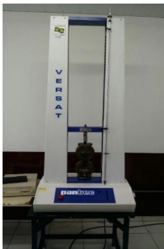
Figura 5. Máquina de tração PANTEC VERSAT 20K.
