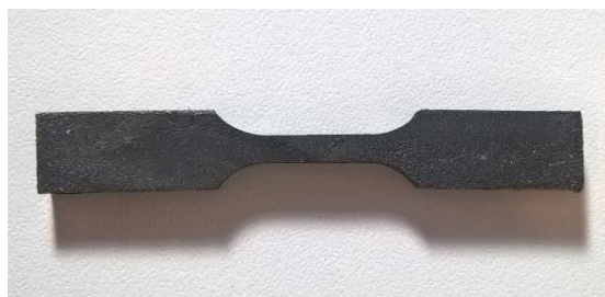
Figura 4. Corpos de prova de (a) UHMWPE e de (b) Acrílico prontos para ensaio.
