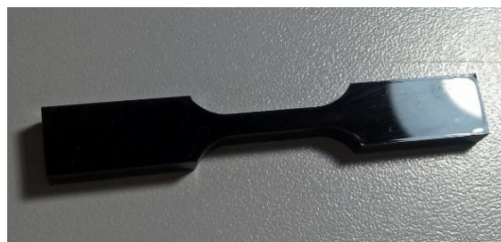
Figura 4. Corpos de prova de (a) UHMWPE e de (b) Acrílico prontos para ensaio.
