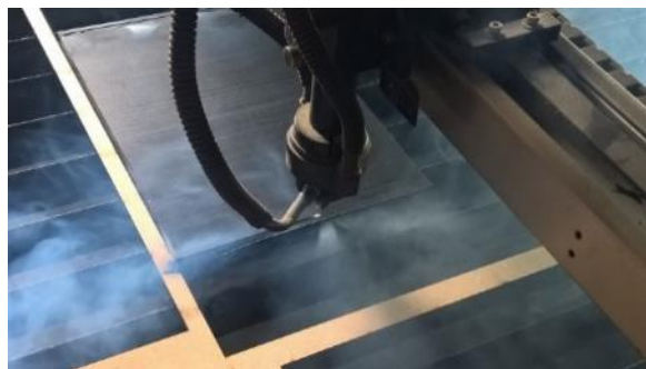
Figura 3. Corte a laser dos corpos de prova.
