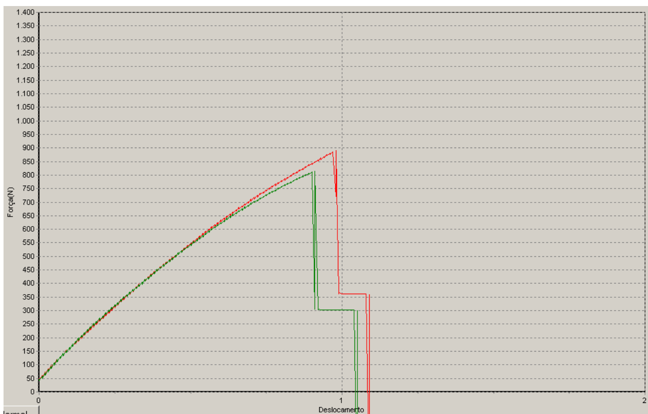
Figura 7. Exemplo do gráfico fornecido pelo software da máquina de tração referente ao ensaio do Acrílico, eixos de força (N) x deslocamento em (mm).
