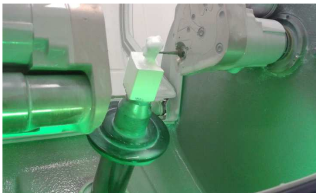
Figura 6 - Confecção de coping para implante odontológico, por sistema CAD/CAM.
