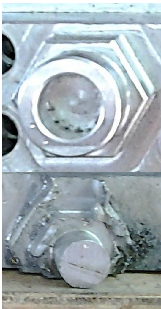
Figura 6 – Região usinada nos diferentes materiais “Amostra A” acima e “Amostra B” abaixo. Fonte: O próprio autor.
