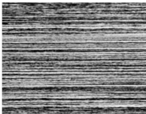
Liga (5057) pertencente a mesma família da amostra “B” utilizada como referencia laminada com 85% de redução (Metals Handbook, 1992).
