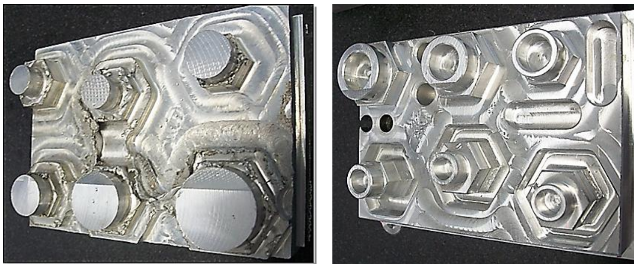
Figura 1 – Peças apresentando resultados, ruins à esquerda e bons à direita, após usinagem.
