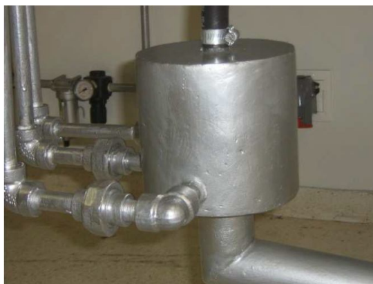
Figura 3. Dispositivo de enriquecimento do ar de combustão
