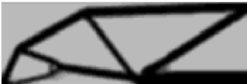
Figura 3: Otimização topológica com restrição de tensões do problema MBB-Beam
