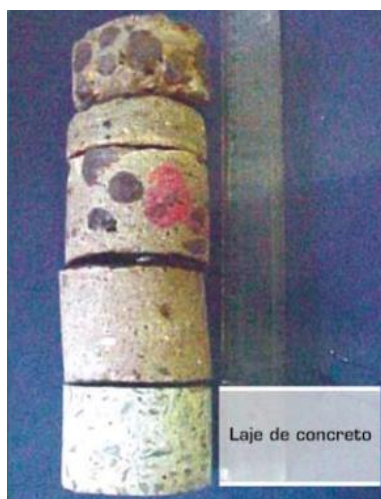
Figura 1. Exemplo de camadas impermeabilizantes sobrepostas. (Fonte: Medeiros, 2008)
