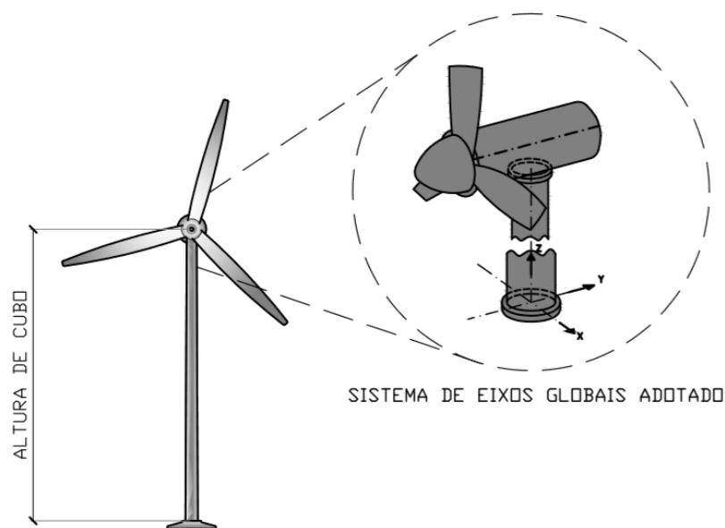
Figura 2 - Sistema de eixos globais adotado.
