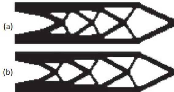
Figura 6. Geometrias alcançadas com (a) Hard-kill BESO tradicional, e (b) Soft-kill BESO
