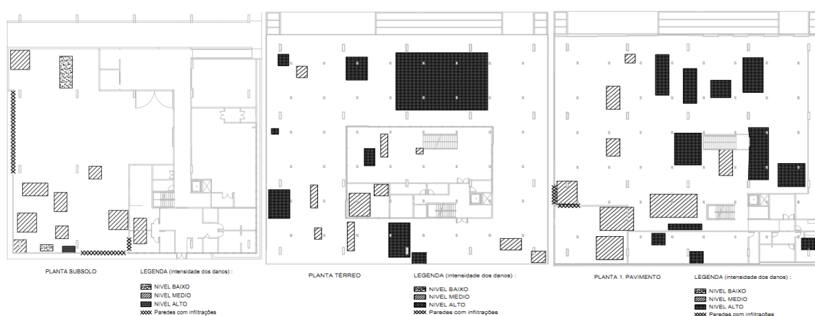
Figura 5. Mapeamento de danos na laje do Edifício do MAB. (Fonte: Relatório de Vistoria 013-2016-SEINST)
