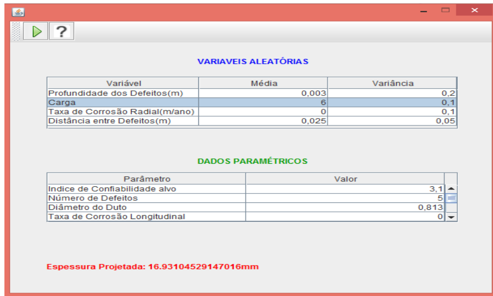
Figura 4 – Interface Gráfica Interativa para o caso de múltiplos defeitos de mesma dimensão alinhados longitudinalmente
