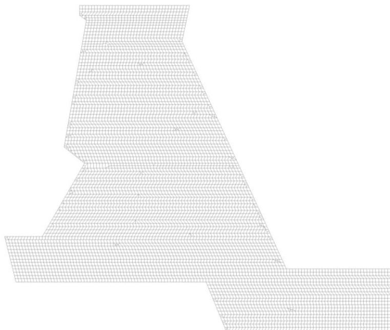
Figura 7 – Malha de elementos Finitos – Elemento Plane183
