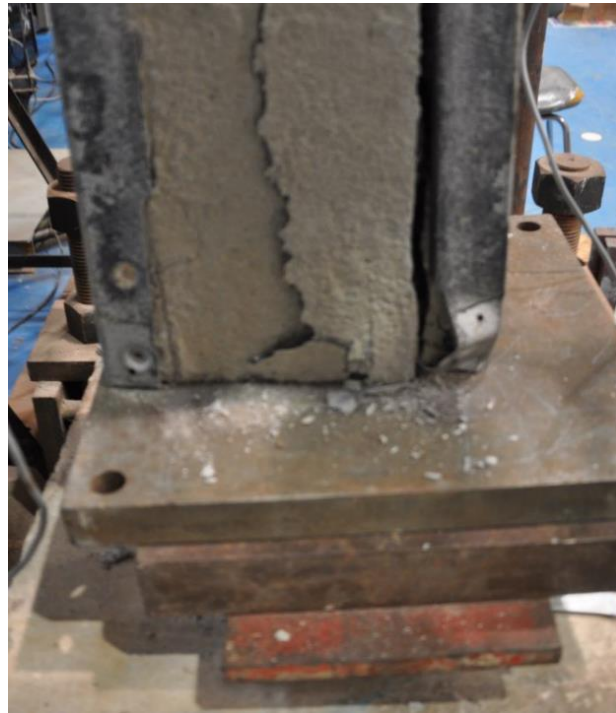
Figura 9 - Pilar 01 após o ensaio de compressão excêntrica.
