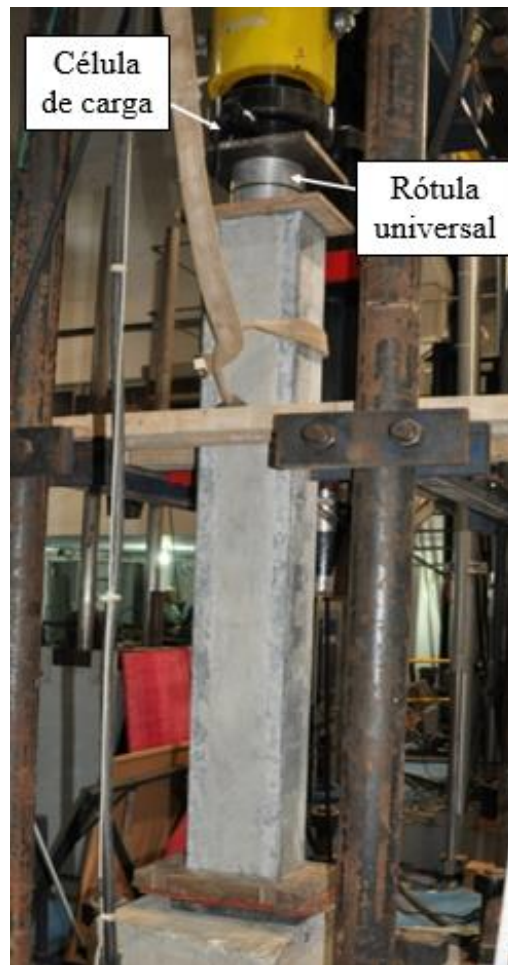
Figura 3 – Montagem do ensaio de compressão axial.
