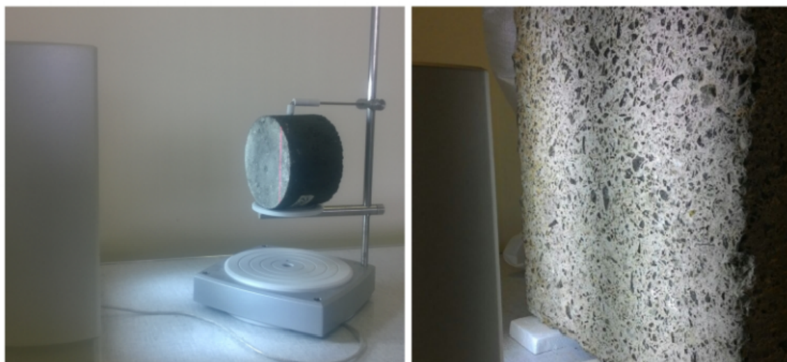
Figura 2: Obtenção dos dados a partir de corpo-de-prova cilíndrico e de placa de concreto.
