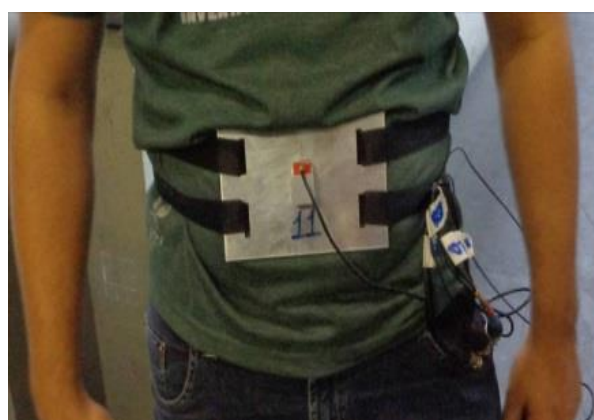
b) Placa com acelerômetro acoplado ao indivíduo
