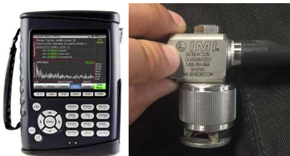
Figura 10. Analisador CoCo-80 (esquerda) e acelerômetro PCB Piezotronics 603C01 (direita).
