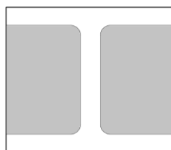
Figura 5. Área (em cinza) da porção de concreto se solidariza à estaca metálica
