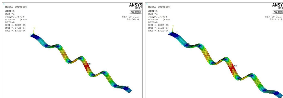
Figura 19. 1º Modo de Flexão vertical para o tabuleiro convencional (esquerda) e para o tabuleiro com dupla ação mista (direita)
