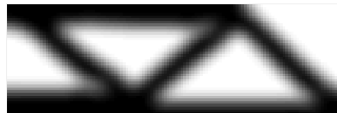
Figura 8: Domínio de projeto 120 \times 40 , filtro da média ponderada das densidades
