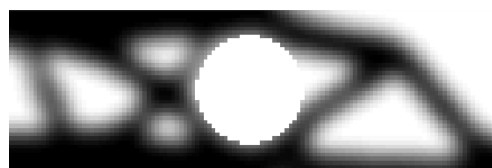
Figura 9: Domínio de projeto 120 \times 40 , filtro do vetor gradiente, com buraco
