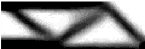
Figura 7: Domínio de projeto 120 \times 40 , filtro do vetor gradiente
