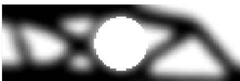
Figura 10: Domínio de projeto 120 \times 40 , filtro da média ponderada das densidades, com buraco
