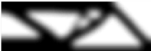
Figura 8: Domínio de projeto 120 \times 40 , filtro da média ponderada das densidades
