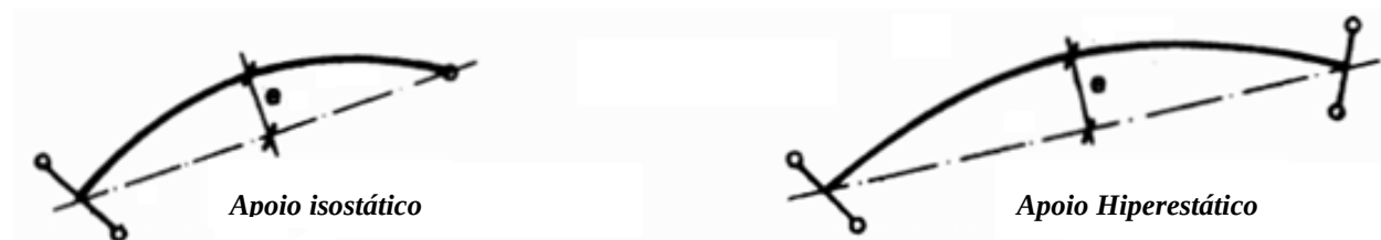
Figura 6. Centro de Gravidade de uma ponte curva com vão único. (Leonhardt, 1979).
