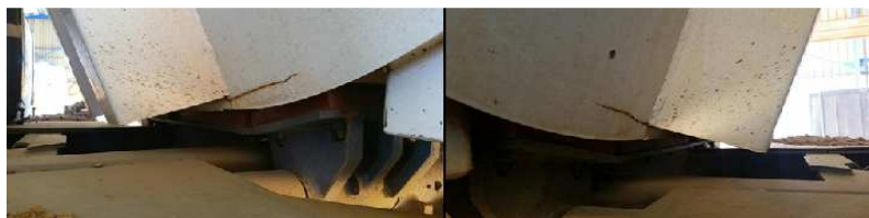
Figura 1. Trincas observadas na caçamba próximas a região de basculamento da caçamba
