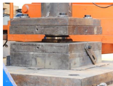
(c) Rótula semiesférica fixa na extremidade inferior do modelo.
