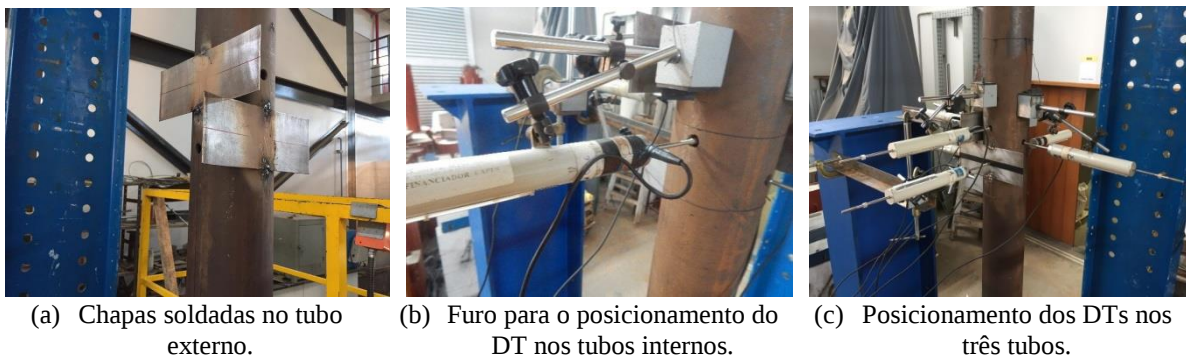
Figura 11. Montagem dos DTs nos modelos.
