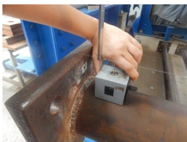
(b) Aferição da distância entre a linha de nylon e a superfície do tubo utilizando o paquímetro.
