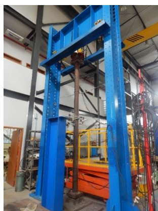
(a) Pórtico utilizado para execução dos ensaios.
