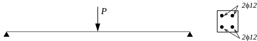
Figura 14. Viga biapoiada - Exemplo 3
