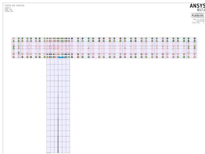
Figura 18. Fissuração da laje de concreto do modelo numérico na região próxima ao apoio interno
