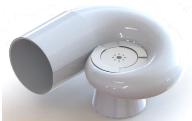
Figura 14: Vista isométrica da turbina Francis.
