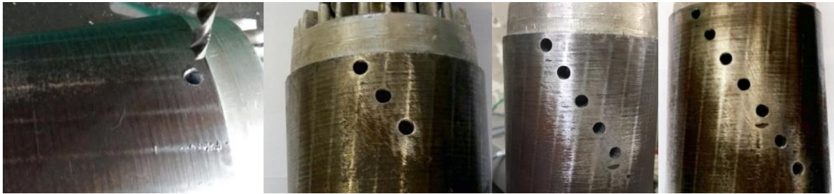
Figura 3. Rotor com uma, três, cinco e sete barras quebradas
