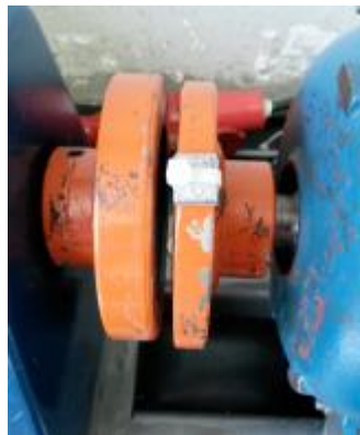
Figura 2. Ensaio de desbalanceamento com motor desacoplado
